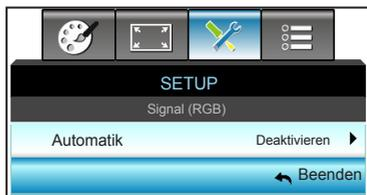
Wählt das Signal automatisch. Wenn Sie diese Funktion nutzen, werden Phase- und Frequenz-Elemente ausgegraut; und falls Signal nicht automatisch ist, können die Phase- und Frequenz-Einstellungen manuell angepasst und in den Einstellungen gespeichert werden (bleiben beim nächsten Aus- und erneuten Einschalten des Projektors erhalten)
