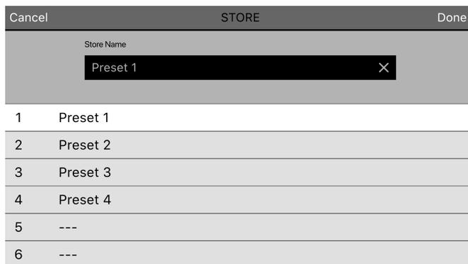
3. Wenn der Bildschirm zur Eingabe des Preset-Namens angezeigt wird, geben Sie den gewünschten Preset-Namen ein und tippen Sie zur Bestätigung auf die Schaltfläche „Done“ (Fertig).
